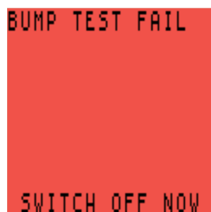
Rysunek 48: Test obciążeniowy zakończony niepowodzeniem – wyłącz detektor
