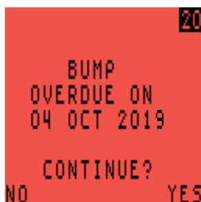
Figure 13 : Bump Overdue (Date du test fonctionnel dépassée)
