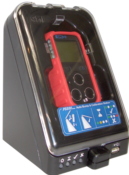
Figure 54 : Station automatique de calibrage et de test au gaz PS200
