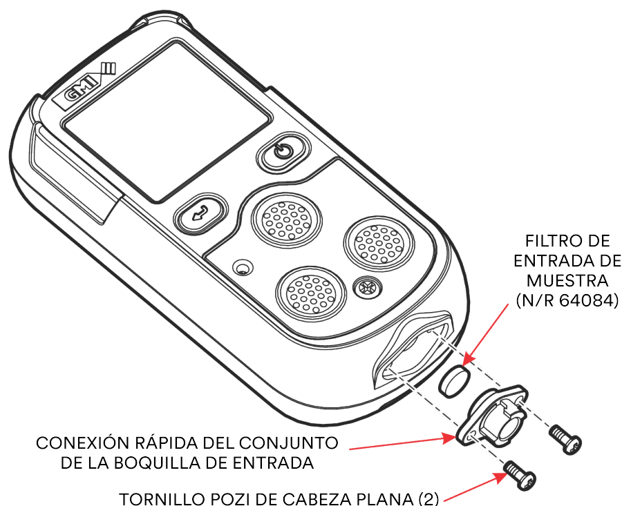
Figure 53: Sustitución del filtro de entrada de muestra (polvo)
