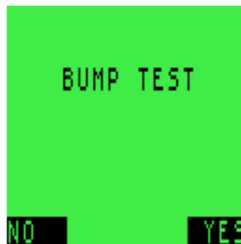
Figure 41: Pantalla de confirmación BUMP TEST (Prueba funcional)
