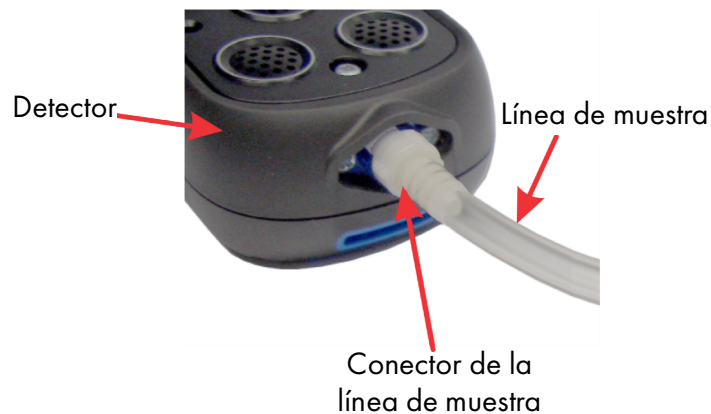
Figure 21: Conexión de la línea de muestra
