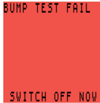
Figure 48: Prueba funcional incorrecta - Apague el detector
