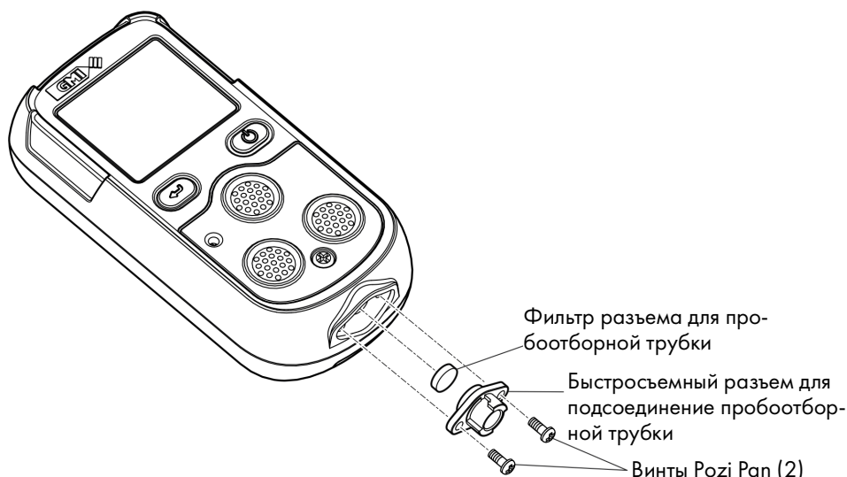
Рисунок 53: Замена противопылевого фильтра на входе пробоотборной линии
