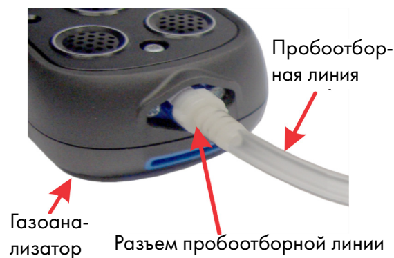
Рисунок 21: Подсоединение пробоотборной линии
